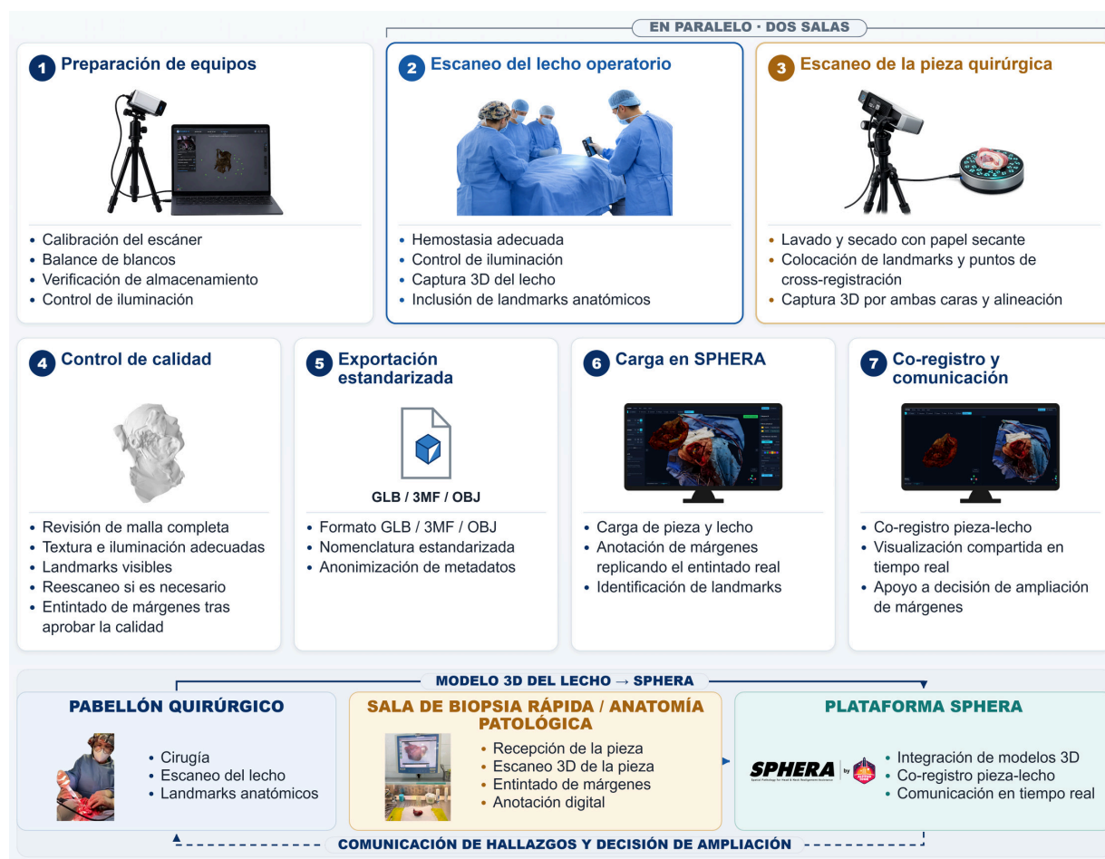
Figura 2. Esquema completo del flujo propuesto, desde la preparación y el escaneo hasta el co-registro y la comunicación. Representación de producto; la adopción en cada centro requiere evaluación local.
